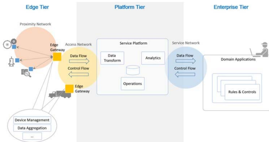
그림 5: 3단계 IIoT 시스템 아키텍처.
